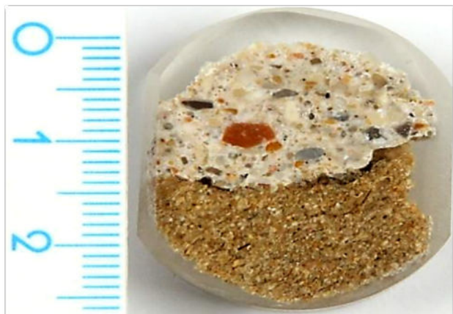
Figura 6 – Sezione lucida del campione 21. La parte superiore contiene aggregati calcarei, di selce e frammenti di cocciopesto. La parte in basso è un frammento roccioso.
